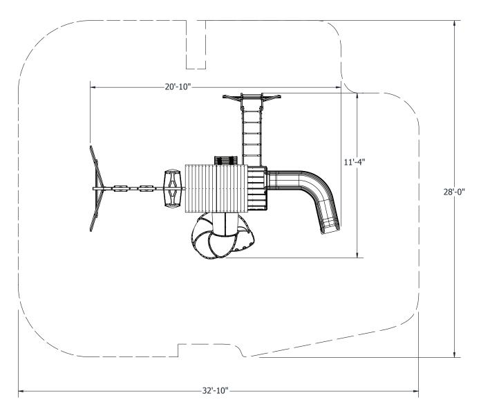
MINIMUM USE ZONE FOR PLAY EQUIPMENT SHALL EXTEND NO LESS THAN  $72^{\circ}$  FROM ALL SIDES OF THE PLAY STRUCTURE.
