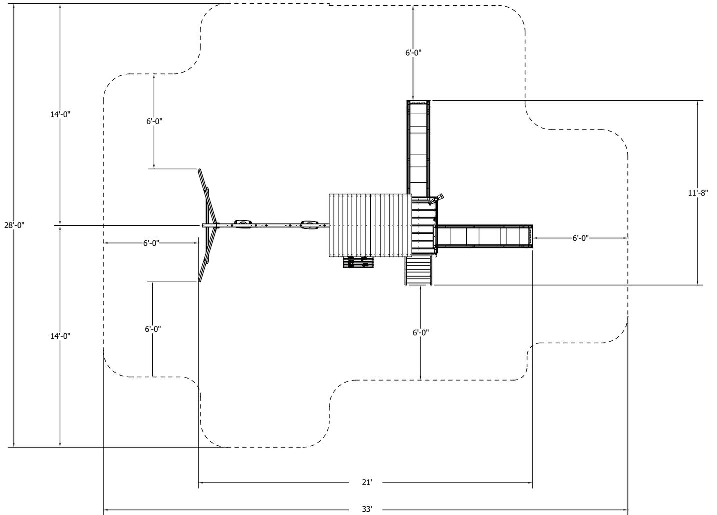
MINIMUM USE ZONE FOR PLAY EQUIPMENT SHALL EXTEND NO LESS THAN 72" FROM ALL SIDES OF THE PLAY STRUCTURE.
