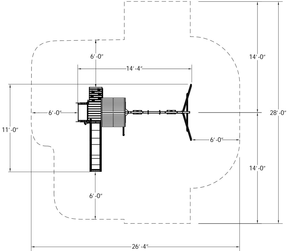
MINIMUM USE ZONE FOR PLAY EQUIPMENT SHALL EXTEND NO LESS THAN 72" FROM ALL SIDES OF THE PLAY STRUCTURE.
