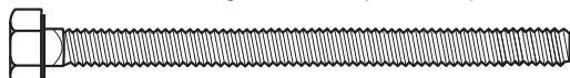
(6) pernos con cabeza hexagonal de 5/16" x 3-1/2" (6) boulons à tête hexagonale de 5/16 x 3 1/2 po
